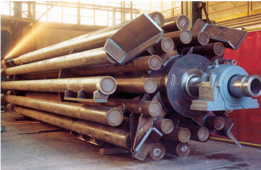
FOTO DEL HAZ DE TUBOS ROTATORIOS CONSTRUIDO BAJO LA NORMA ASME A 150 PSI
